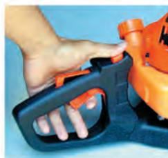
Pulse el botón de bloqueo para cambiar el ángulo de la empuñadura ajustable. Esto sólo resultará posible si la palanca de aceleración se encuentra suelta.
