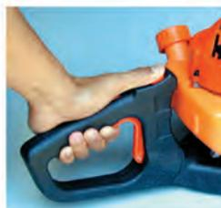
No es posible pulsar el botón de bloqueo si las cuchillas se encuentran en movimiento. El operario ha de soltar la palanca de aceleración antes de pulsar el botón de bloqueo para cambiar la posición de la empuñadura.
