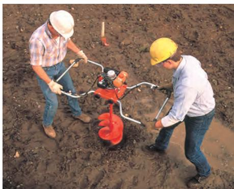
No precisan ningún tipo de suministro eléctrico. Ideales para perforar orificios grandes y profundos en exteriores utilizando una barrena helicoidal, tal como se muestra en la fotografía (barrena helicoidal disponible como accesorio opcional).
